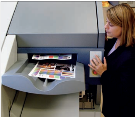
Digitaltrykk: Nexpress. Ved det oversiktlige utlegget kontrollerer operatøren trykkresultatet
