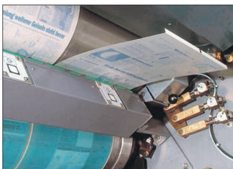
Automatisk plateskift er i ferd med å bli regelen – også på rullpresser. Her på en avispresse fra MAN-Roland.
