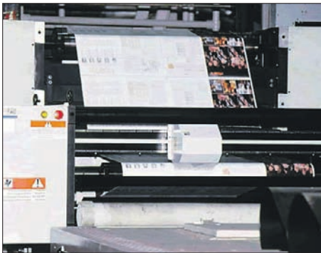
Closed-loop-systemer fra henholdsvis QTI (over) og GMI (under) montert på heatsetpresser.
